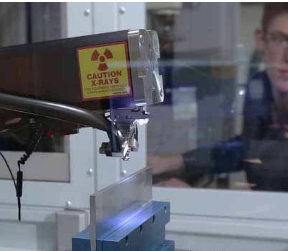
Der Proto LXRD dient zur sorgfältigen Messung der verbleibenden Materialbelastung nach dem Schleifvorgang, um eine geschlossene Schleifauswertung zu gewährleisten
