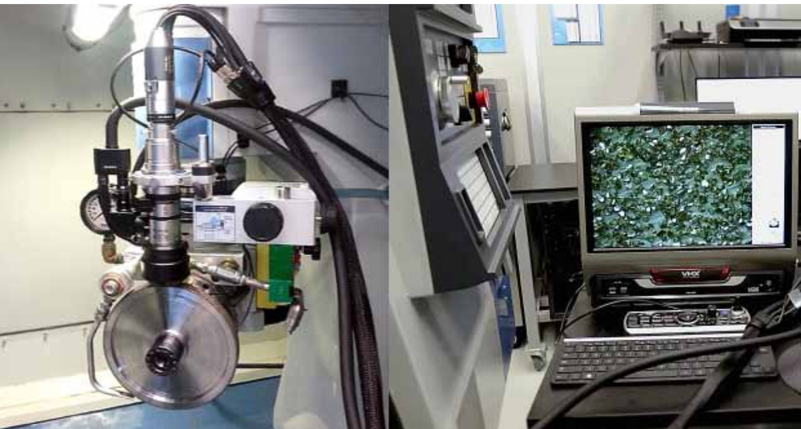
Das Keyence VHX 2000 Digital 3D Mikroskop hat ein individuelles Befestigungssystem, welches Aufnahmen vom Rad an der Spindel ermöglicht
